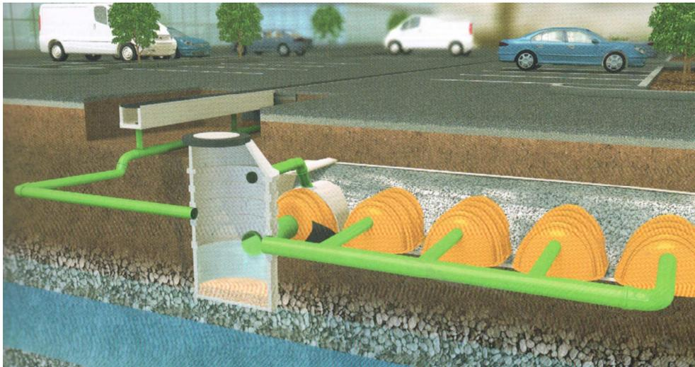
**Abb. 4:** Anwendungsbeispiel für BIRCO-Rigolentunnel bei hohem Grundwasserstand. Das System ist auch unter dauerhafter Schwerlastbefahrung, z.B. unter Stellplätzen und Einfahrtbereichen, möglich. (Quelle: BIRCO).
